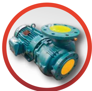
Motobombas IHM | Centrífugas Eurolinea® Monoblock | Trifásicas | 220V/440V | 3500 RPM | IE3
